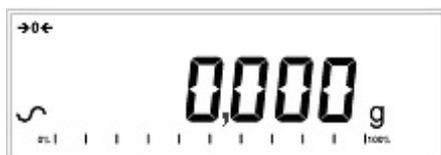
当水份分析仪稳定后屏幕将显示稳定符号~。在不稳定的情况下符号将不显示。当水份分析仪处于零点时在屏幕左上方将显示符号“**→0←**”
