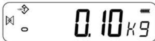
Pour changer l'unité de pesée, appuyez sur la touche **[Unités]**. Les différentes options d'unité de pesage peuvent être activées par l'utilisateur dans la section des paramètres. Voir section 10.
