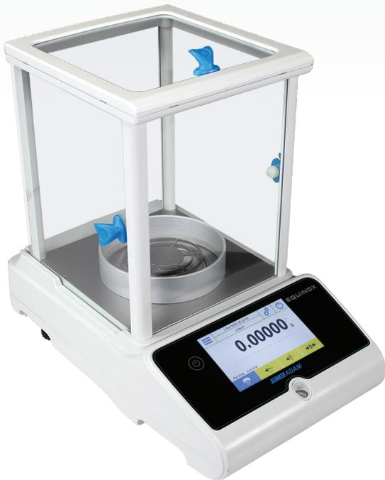
Die Equinox Analysenwaagen liefern eine bemerkenswerte Präzision, um detaillierte Tests in Laboren durchführen zu können. Die Equinox ist ideal für die Bereiche Forschung, Qualitätssicherung, Wissenschaft und Ausbildung sowie für Produktions- und Fertigungsanwendungen, die außergewöhnlich präzise Ergebnisse benötigen. Die Equinox besitzt ein farbiges Touchscreen-Display für intuitive Bedienung, icon-gesteuerte Menüs sowie leicht zugängliche Anwendungen und Funktionen.
