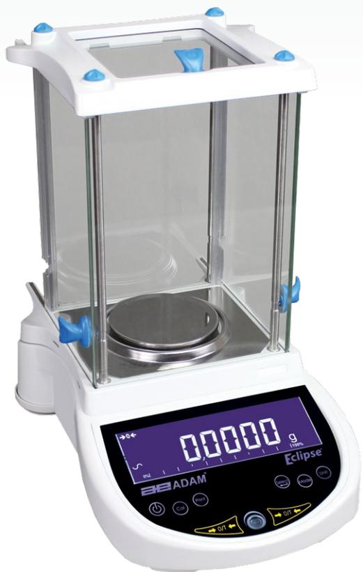
为先进的科学家和科学研究人员量身打造的Eclipse分析天平，提供了量程从100g到310g的型号，精度为0.1mg。电容式触摸键盘上彩色按键颜色明亮，对天平功能和特征的导航简单清晰。Eclipse拥有的显示屏是工业行业中最大的LCD显示屏之一，它是在深蓝色的背景光下显示大的白色数字，确保读数清晰可见。清晰可辨的标识和多种语言的文字方便了操作，使最复杂的工作变得简单。Eclipse的创新设计缩小了它的体积，所以在实验室工作台上占用的空间很小，但却保持着高水准的运作。连接，无论是它的基本数据打印，还是更先进的与LIMS连接，都能通过USB和RS-232接口实现。打印结果上会显示时间、日期已经其他GLP规范要求的相关信息。Eclipse的各种型号用户都可以对内部校准和外部校准选择使用。
